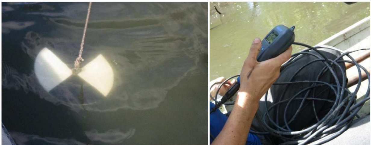
Figura 3 - Disco de Secchi utilizado para medição de transparência e profundidade (a); Sonda multiparamétrica de onde foram fornecidos os valores de variáveis ambientais (b).
