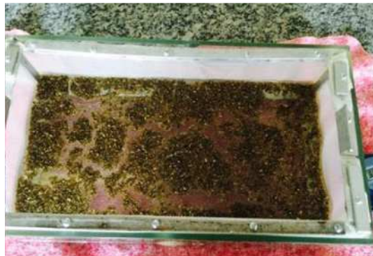
Figura 19 - Tela com sisal imersa no reservatório de vidro simulando um corpo aquático contaminado com gasolina (sistema completo).
