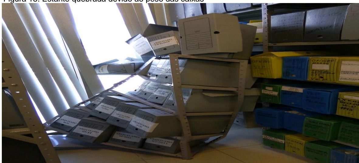
Figura 15: Estante quebrada devido ao peso das caixas
