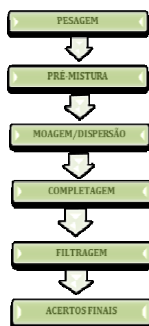
Figura 18 – Fluxograma Geral de Fabricação das Tintas Líquidas.
