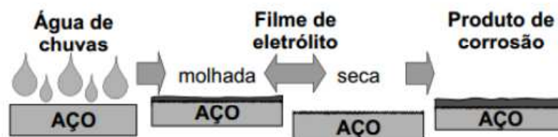
Figura 11 – Efeito de Alternância Molhado e Seco no Aço.
