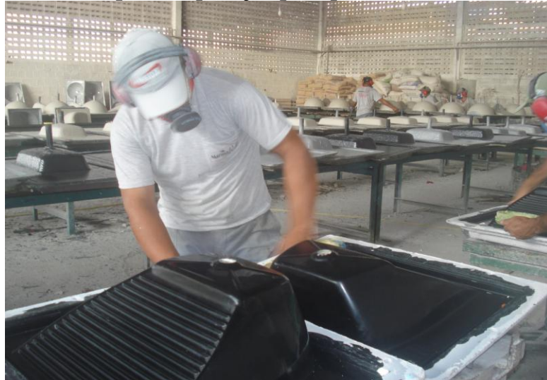
Foto 7: Etapa 3 Preparação para preenchimento
