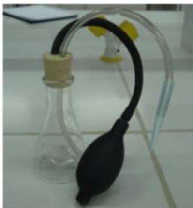
Figura 3 - Sistema pneumático de transferência de líquidos para béquer.
