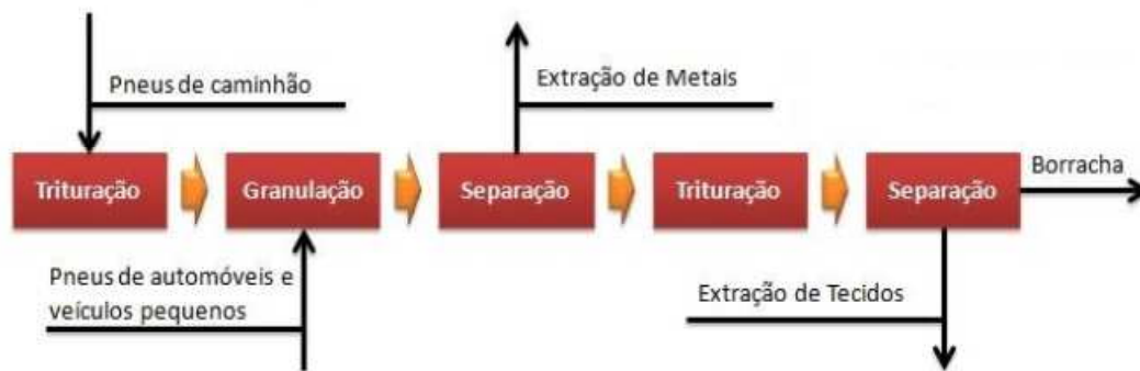
Figura 4 - Etapas do processo de fragmentação de pneus.
