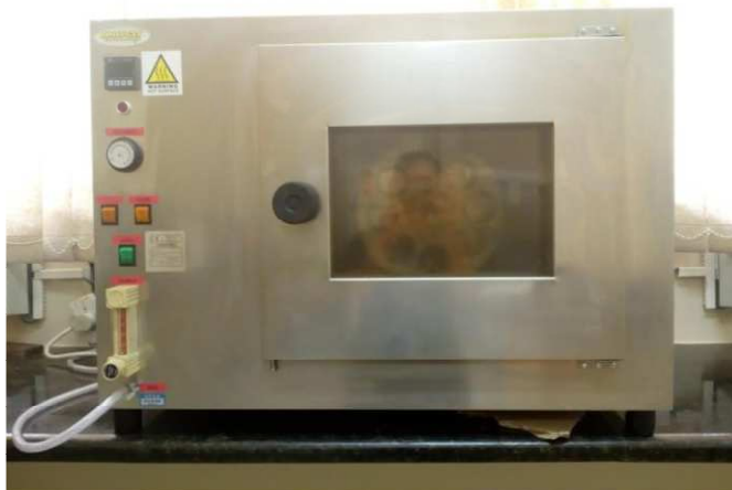
Figura 14 - Envelhecimento a curto prazo (RTFOT) (LEP/UFCG).
