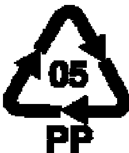
Figura 1 – Identificação do polipropileno em materiais recicláveis.
