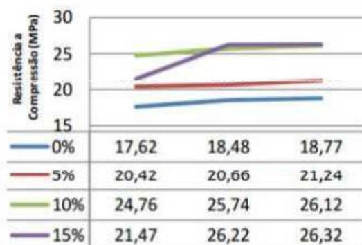
**Figura 12 -** Gráfico dos valores de resistência a compressão aos quatorze dias de cura.
