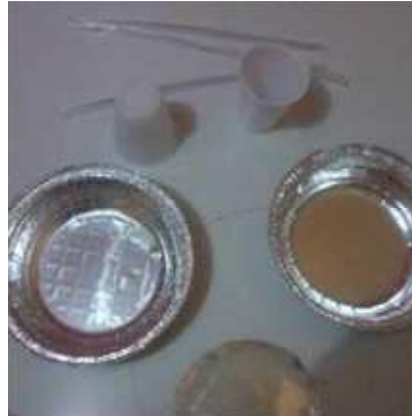
Figura 7: Alguns materiais para a montagem do eletróforo
