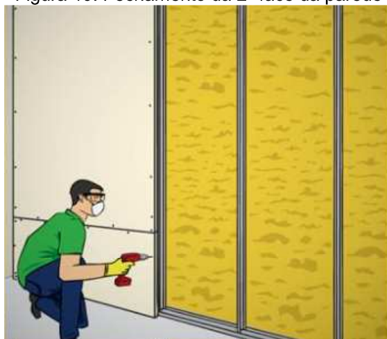
Figura 19: Fechamento da 2ª face da parede
