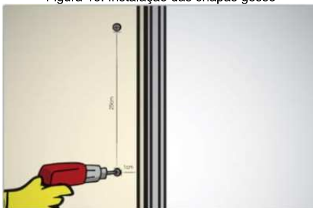
Figura 15: Instalação das chapas gesso
