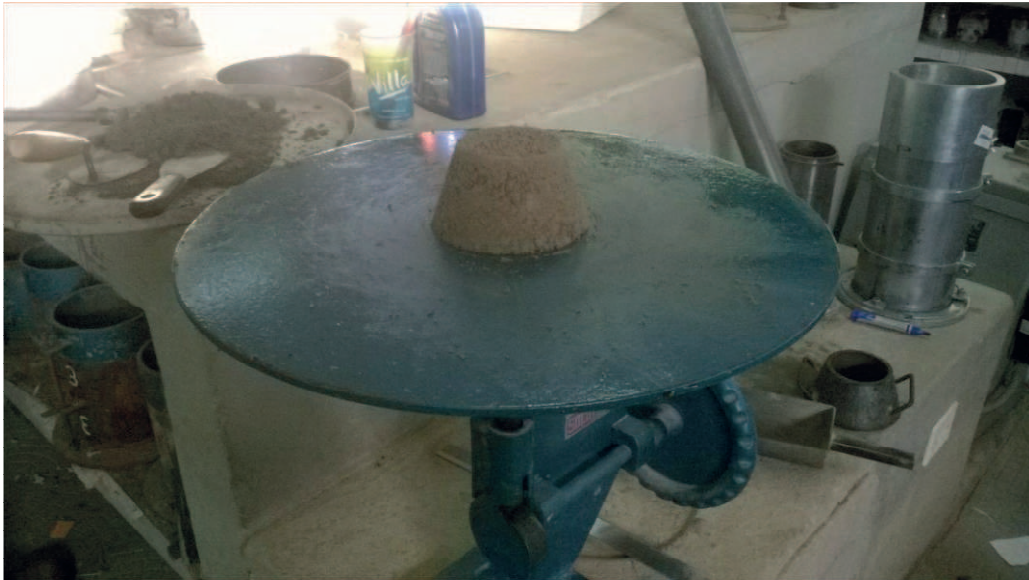
Figura 7 – Determinação do Índice de Consistência
