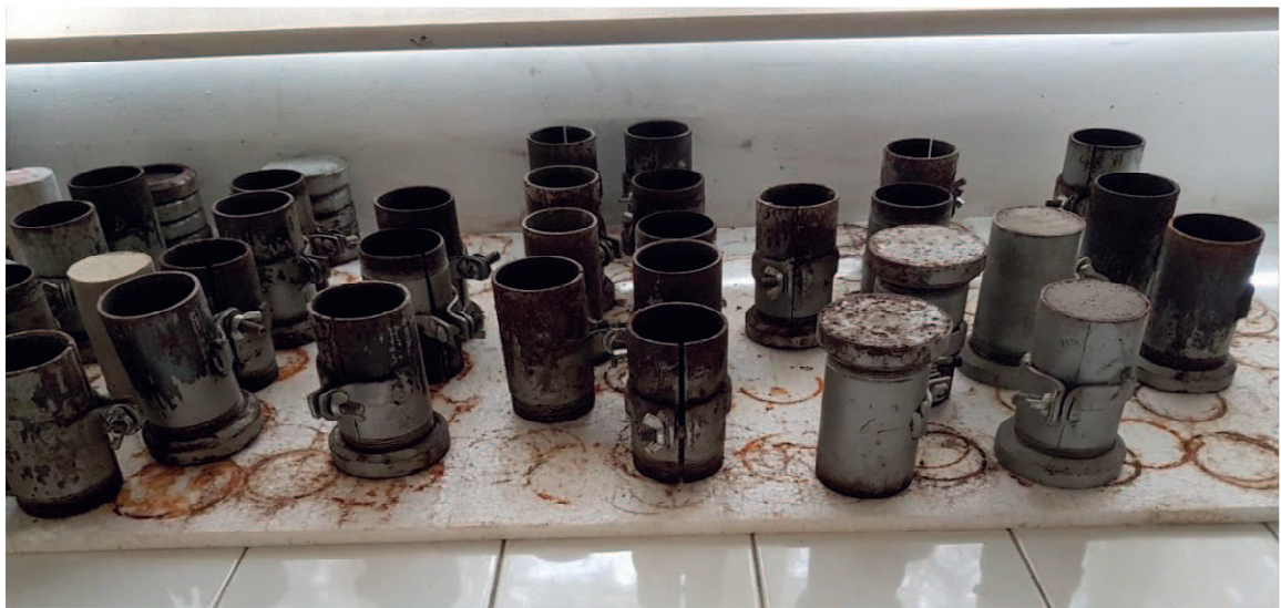
Figura 4 – Preparo dos Corpos de Prova
