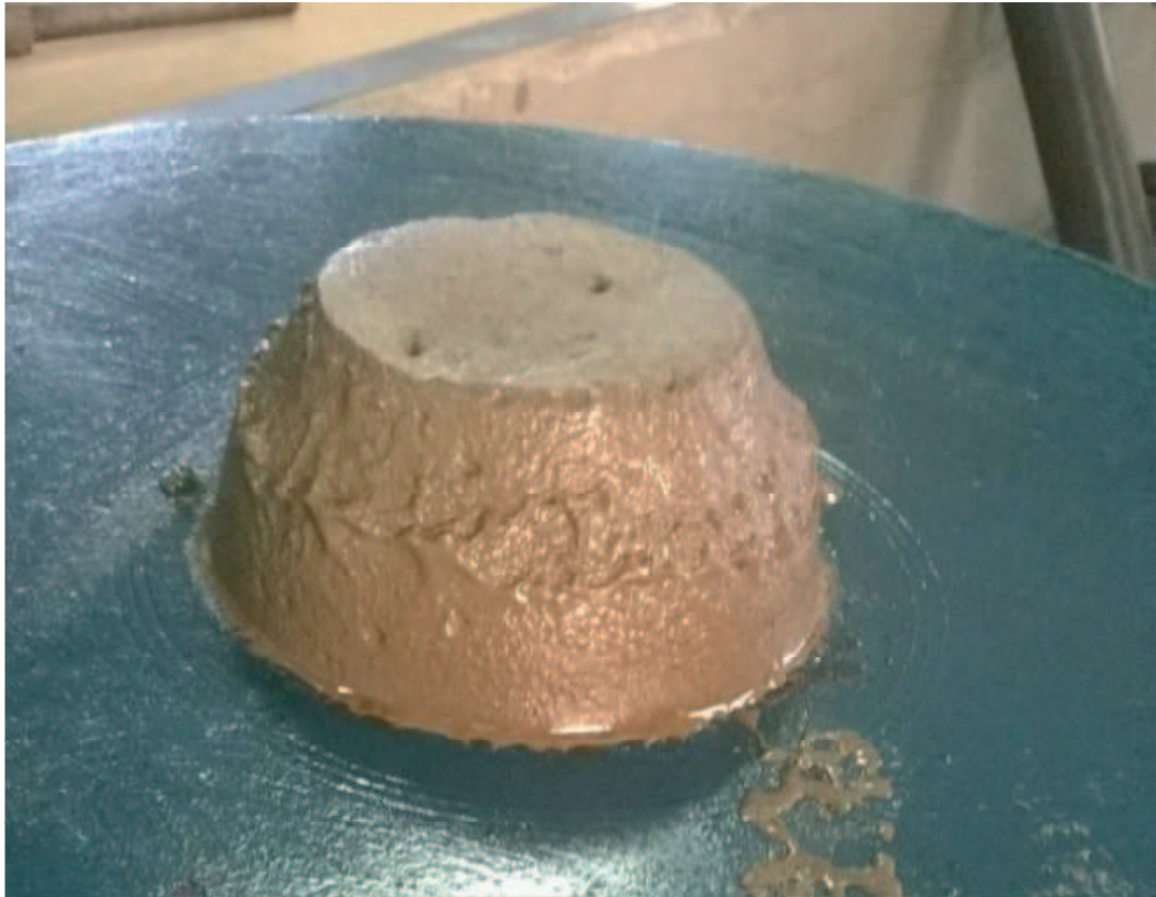
Figura 6 – Determinação do Índice de Consistência
