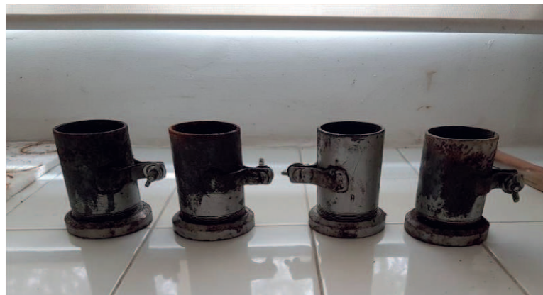
Figura 3 – Molde dos Corpos de Prova
