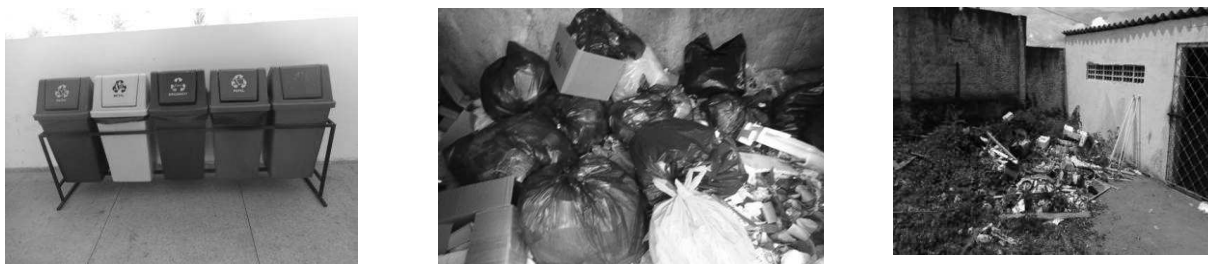
Figura 2: Coletores de Coleta Seletiva; Armazenamento dos resíduos sólidos e o local de disposição dos resíduos sólidos no CIAC, onde se verifica o descarte inadequado de resíduos perigosos (lâmpadas fluorescentes).
