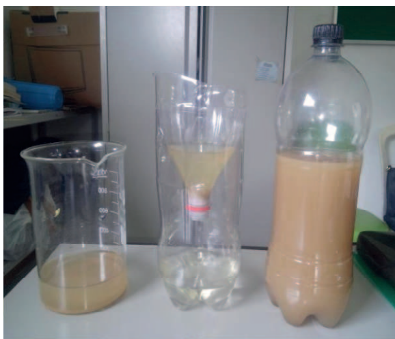
Figura 16: Demonstração de filtragem com uso da semente de Moringa
