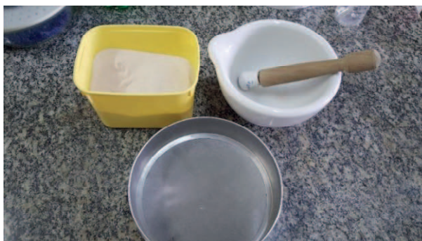
Figura 17 - Aparelhagem utilizada para trituração e tamisação da argila.
