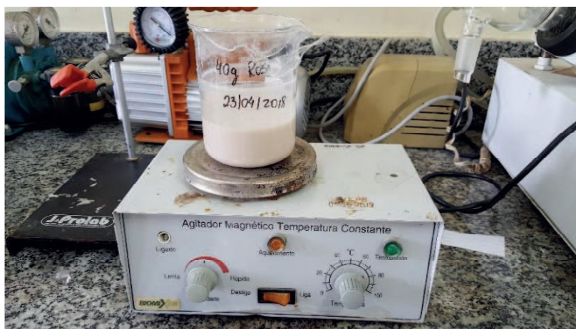
Figura 18 - Agitação da dispersão em agitador magnético.
