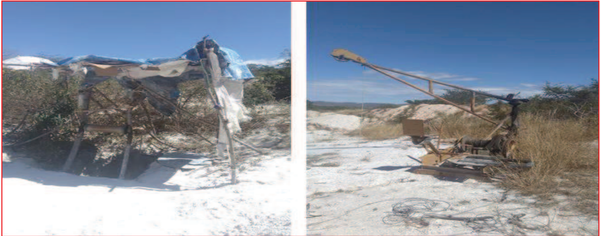
Figuras 10 e 11: Extração tradicional (manual) e a extração de guincho
