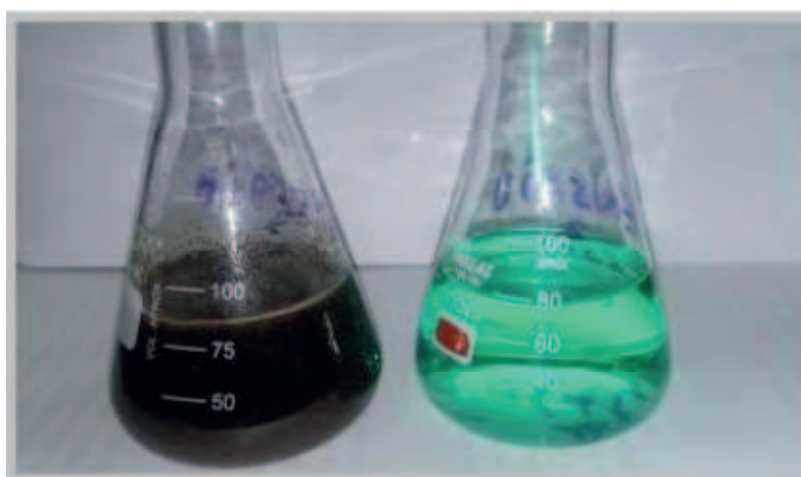
Figura 14: Sistema de bioadsorção (colação marrom opaco) e resíduo bruto (coloração verde translúcido). Fonte: Própria .
