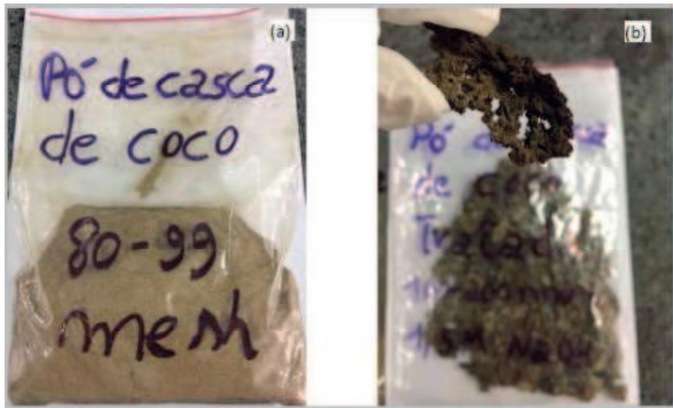
Figura 6: Pó de casca de coco verde (figura 4a: pó de casca de coco verde 80-90 mesh sem tratamento químico; figura 4b: pó de casca de coco verde 100-200 mesh com tratamento químico).
