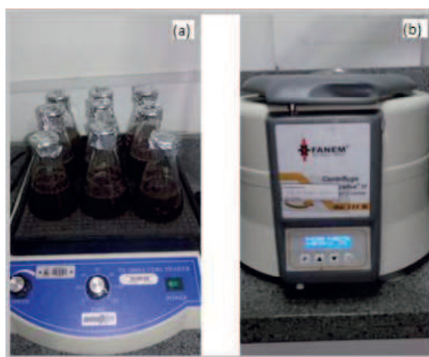
Figura 7: Tratamento de resíduo de niquelagem por adsorção com pó de casca de coco verde tratado quimicamente (figura 7a: sistemas de bioissorção sob agitação em shaker; figura 7b: centrifugação de biomassa misturada ao resíduo).
