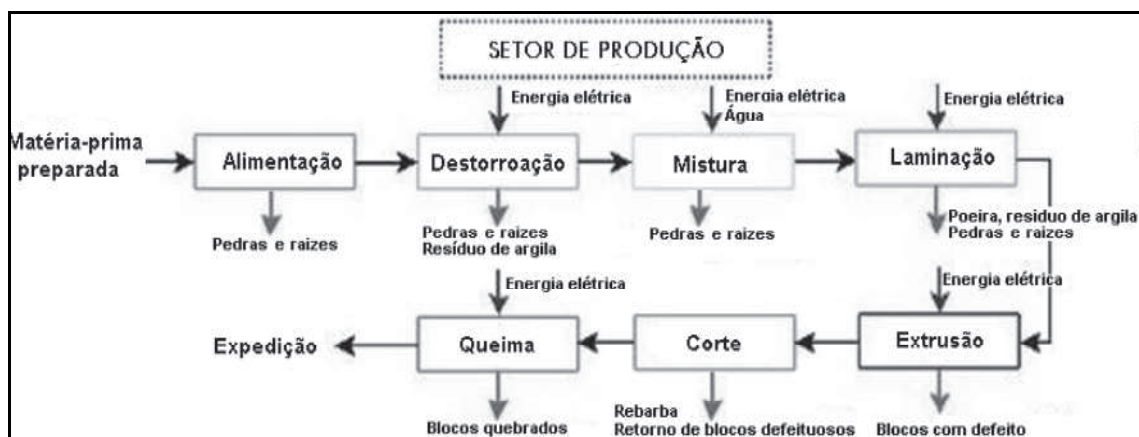
Figura 2 – Esquema do processo produtivo, entradas e saídas de insumos.
