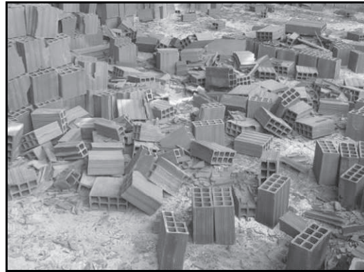
Figura 17 – Perdas de produtos após a queima (resíduos).
