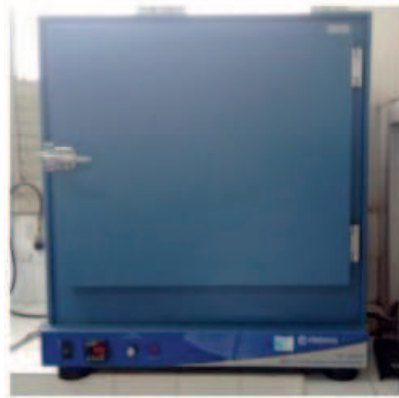
Figura 12. Estufa de secagem TECNAL TE 393/2
