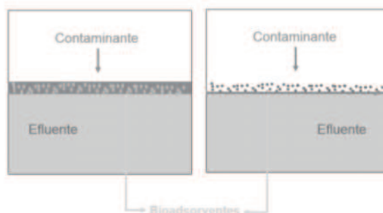
Figura 5. Representação do leito diferencial
