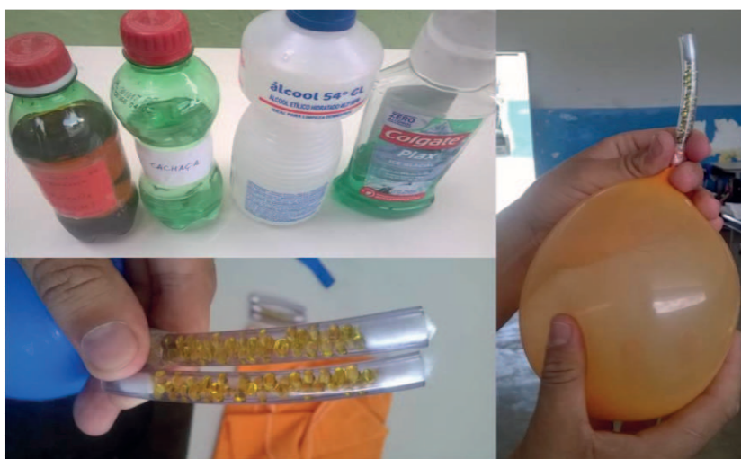
Figura 1: Atividade experimental utilizando bafômetro alternativo de dicromato de potássio.
