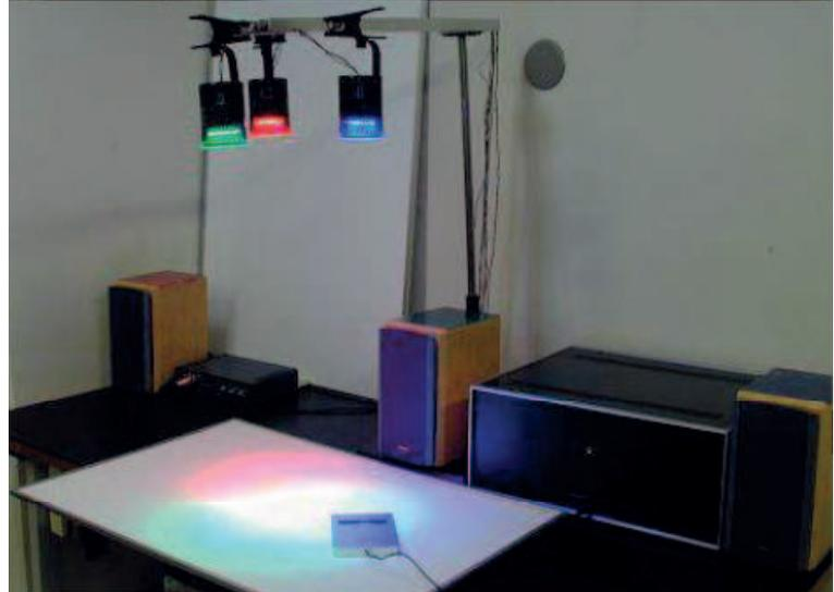
**Figura 16:** Sound spot (ponto de som) constituído por três spots de cores diferentes (vermelho, verde e azul), que conectados a instrumentos de uma banda, cada cor enviará um fluxo de áudio diferente. Se o fotodetector receber apenas uma portadora apenas aquele áudio será ouvido [HARUYAMA, 2011].
