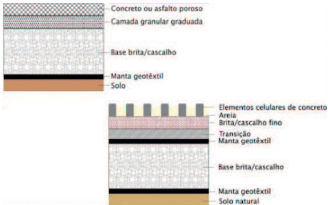
Figura 4: Perfil da pavimentação
