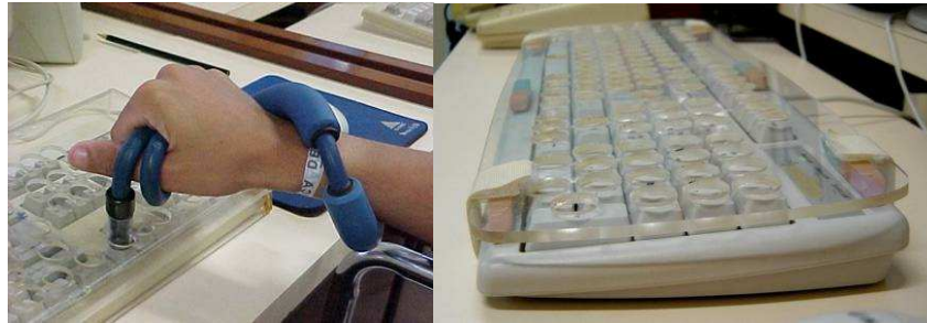
Figura 2 - Tecnologias assistivas. Estabilizador de punho com abdutor de polegar e máscara de teclado sobreposta ao mesmo.
