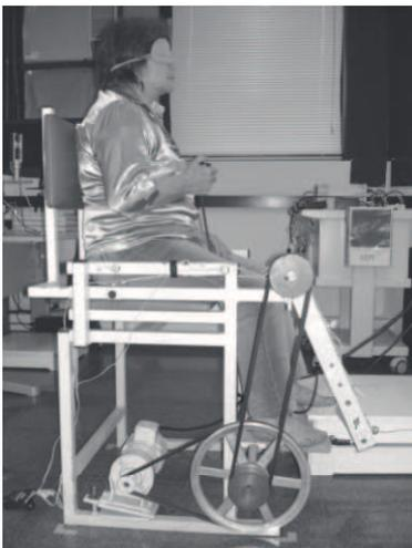
**FIGURA 2** – Ilustração da situação experimental para avaliação da detecção de movimento articular passivo do tornozelo.
