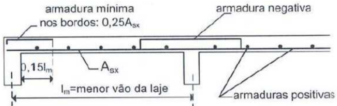
Figura 10 - Posicionamento das armaduras de flexão em corte.
