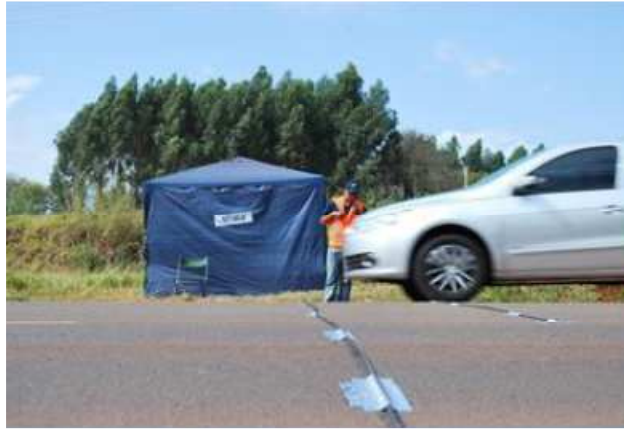
Figura 5 – Exemplo de contagem pelo método automático ( www.strata.com.br/contagem-de-traffic-classificatoria-e-volumetrica , 2017)
