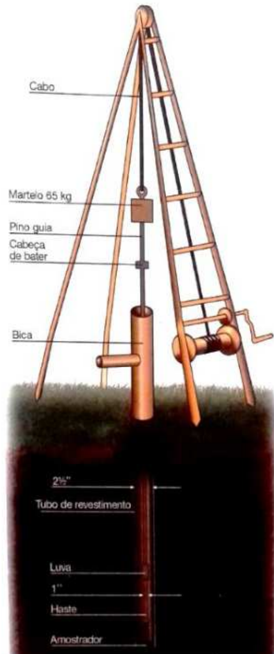
Figura 4 - Equipamento de sondagem.
