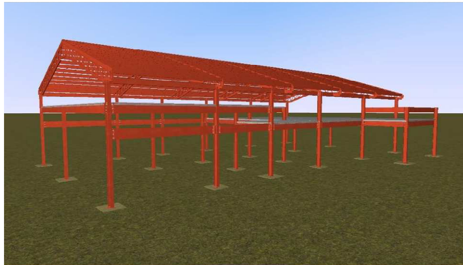
Figura 13- Vista 3D renderizada da estrutura dos mezaninos (vista lateral esquerda da edificação)
