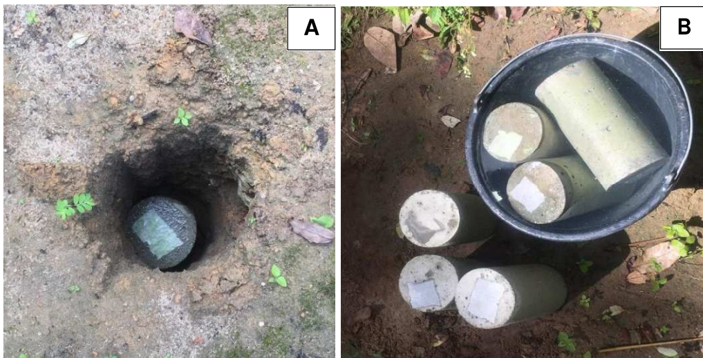
Figura 9 – Simulação de ambientes agressivos. A) Contato com solo, B) Marinho e Gás carbônico
