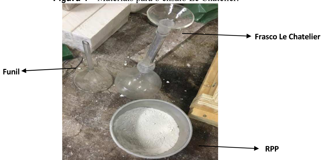
Figura 4 – Materiais para o ensaio Le Chatelier.
