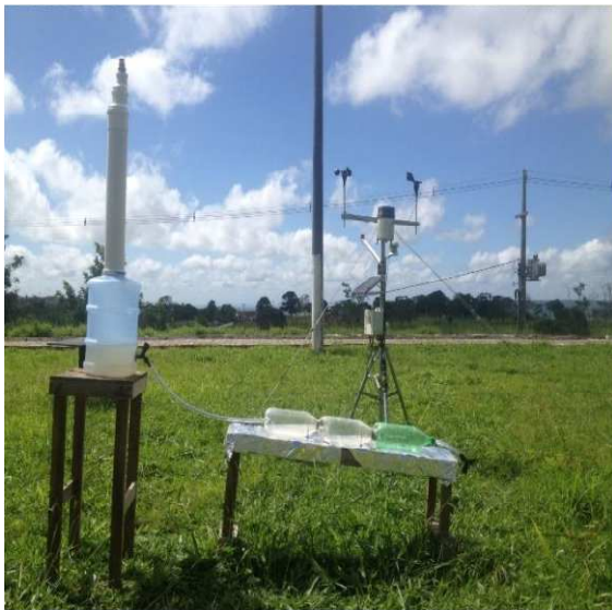
Figura 10 – Filtro lento – canal de desinfecção – vista lateral.
