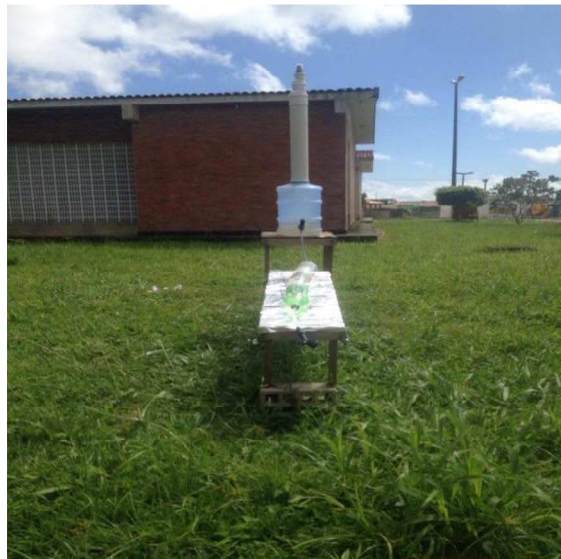
Figura 11 – Filtro lento – canal de desinfecção – vista frontal.
