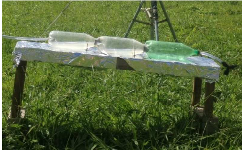
Figura 8 – Canal de desinfecção.
