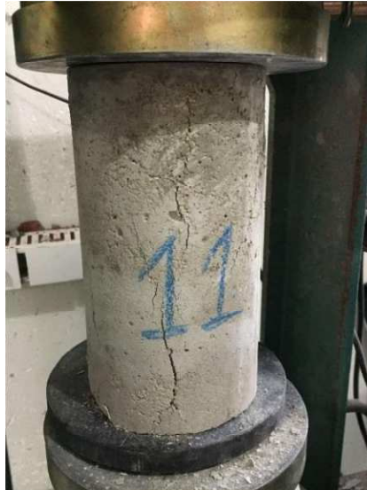
Figura 11 – Forma de fratura dos corpos de prova: colunar
