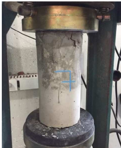
Figura 12 – Fratura típica de defeitos no arremate de topo e base de corpos de prova
