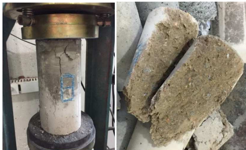
Figura 10 – Forma de fratura dos corpos de prova: cisalhamento
