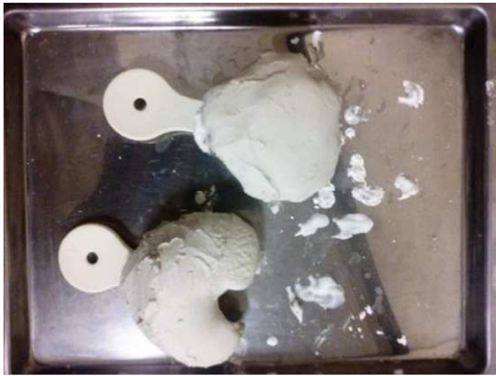
Figura 11 – Vazamento do gesso
