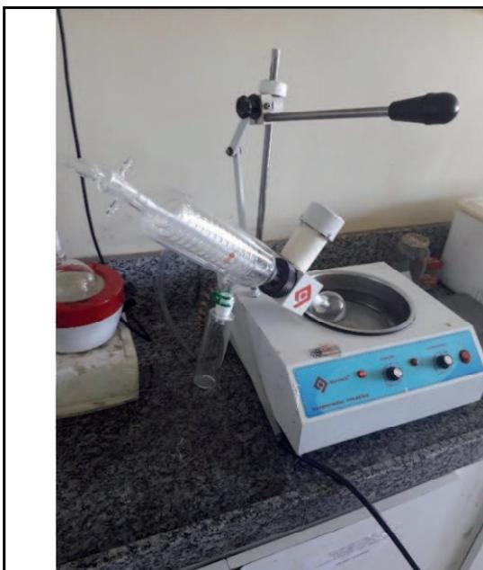
Figura 7 – Evaporador Rotativo para secagem de produtos, modelo QUIMIS, pertencente ao LAPEQA da UEPB
