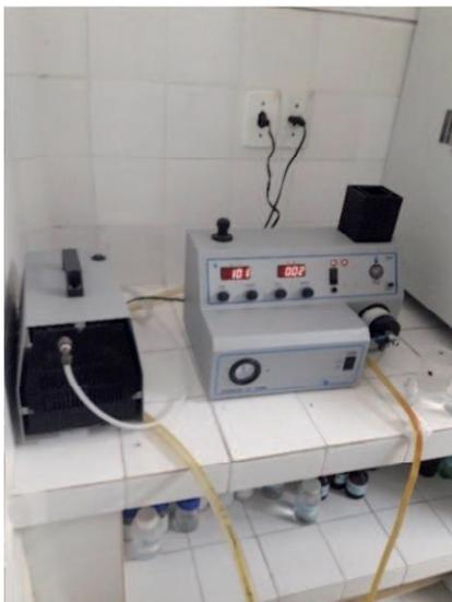
Figura 9 – Fotômetro de Chama, modelo ANALYSER
