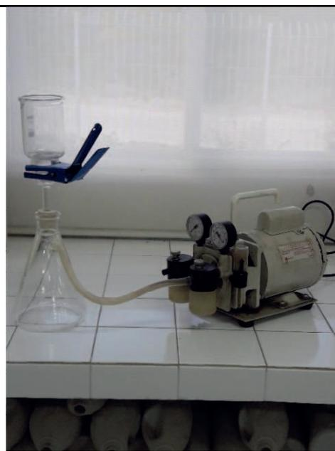
Figura 8 – Sistema de filtração a vácuo que antecede a secagem de produtos
