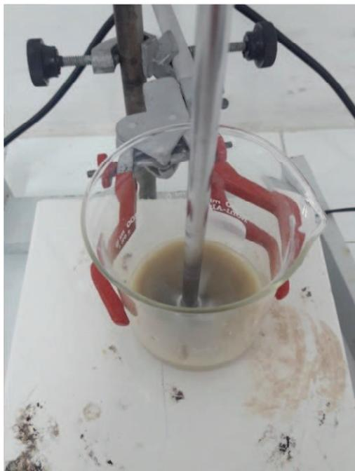
Figura 11 – Síntese do híbrido Quitosana  $\beta$ /Vermiculita Expandida
