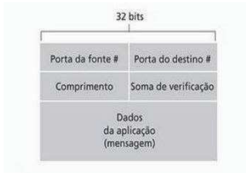
Figura 8: Estrutura do segmento UDP
