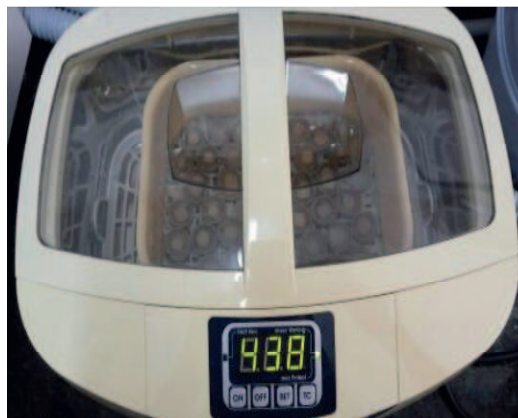
Figura 2. Limpeza dos espécimes em cuba ultrassônica.
