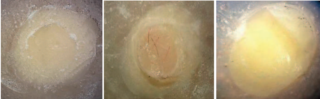
Figura 7. A. Falha adesiva; B. Falha coesiva; C. Falha mista.
