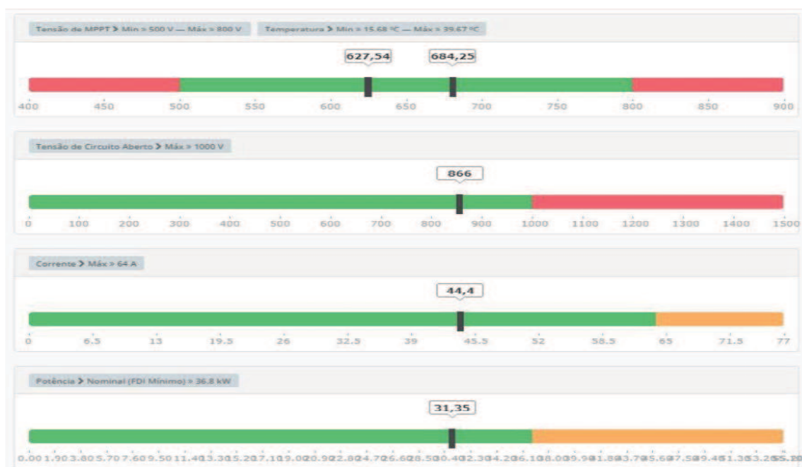
Figura 40 - Limites de entrada de tensão, corrente e potência no inversor ABB 27,6 kW
