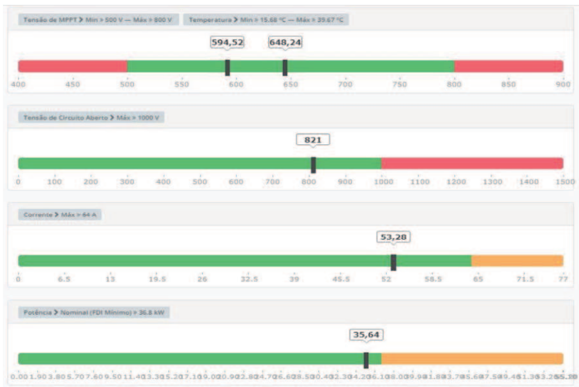
Figura 36: Limites de entrada de tensão, corrente e potência no inversor ABB 27,6 kW
