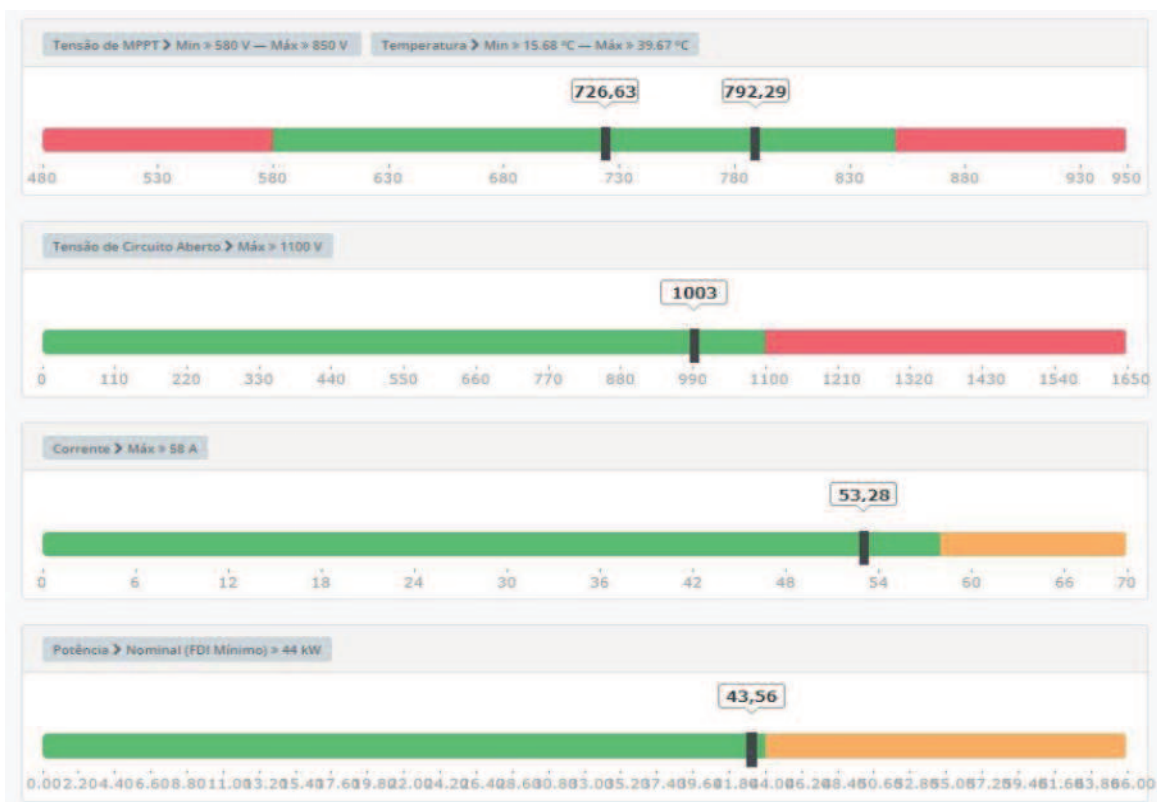
Figura 35: Faixa ótima para entrada de tensão, corrente e potência no inversor ABB 33 kW.
