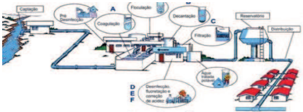
Figura 1: Estação de Tratamento de Água (ETA) do Tipo convencional
