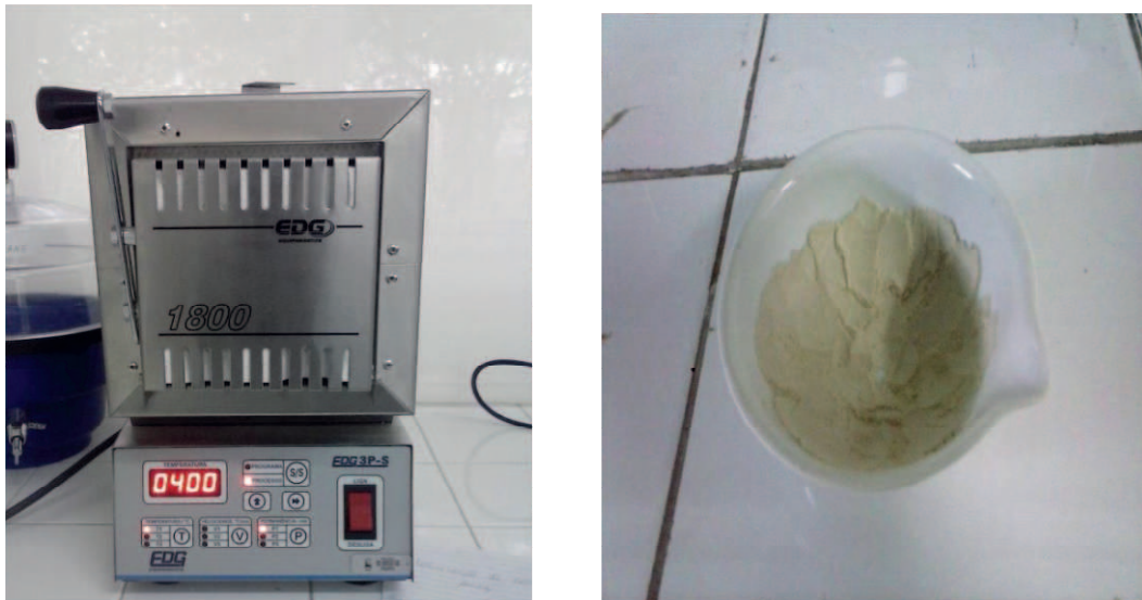
Figura 18: Forno mufla com rampa e vermiculita após o processo de calcinação.
