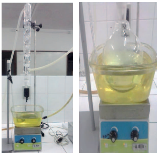
Figura 17: Sistema utilizado para realizar o processo de intercalação da argila.
