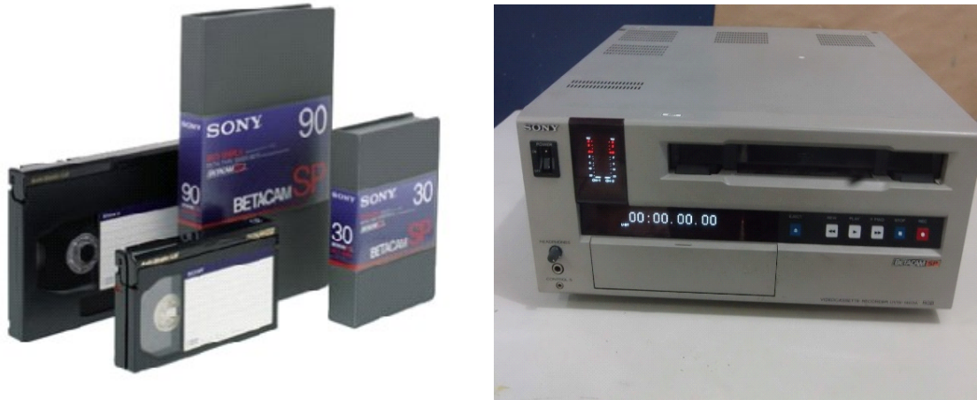
Figura 6 – Fita Betacam: (a) Exemplo de Fitas Betacam; (b) Aparelho de reprodução das fitas Betacam.
