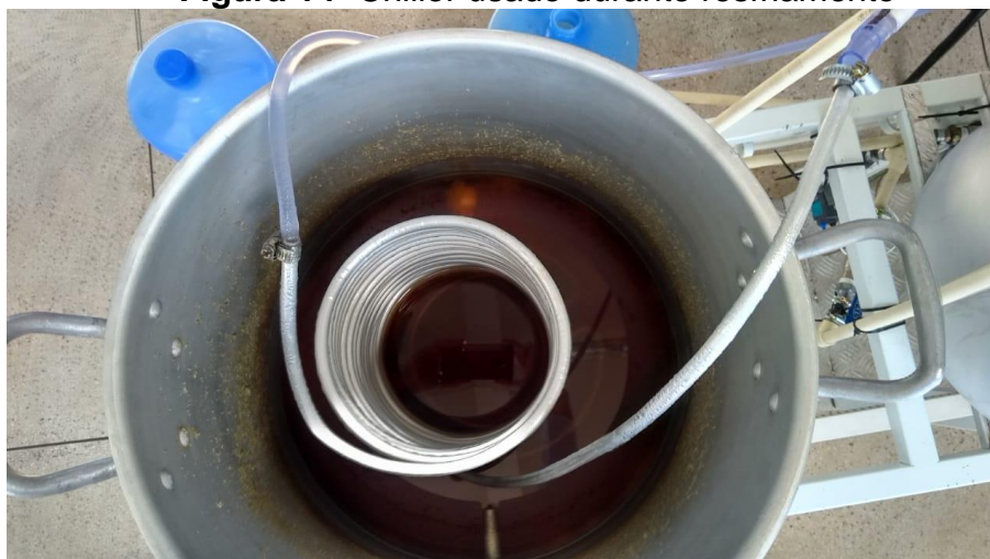
Figura 14- Chiller usado durante resfriamento
