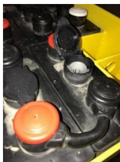
Figura 5: Válvula para adição de água
