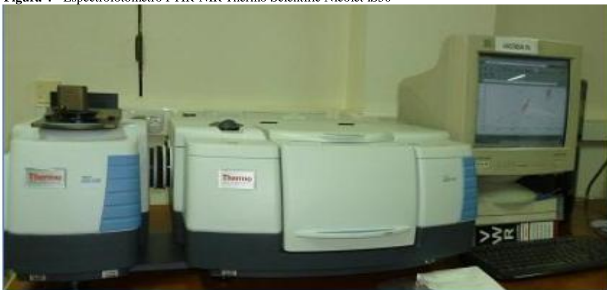
Figura 4 - Espectrofotômetro FTIR-NIR Thermo Scientific Nicolet iS50
