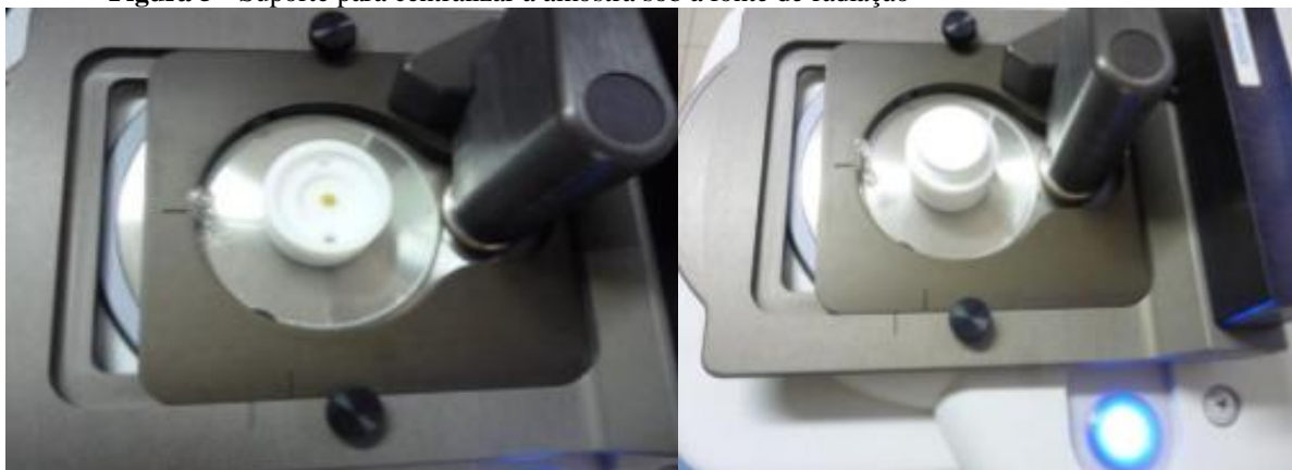
Figura 5 - Suporte para centralizar a amostra sob a fonte de radiação
