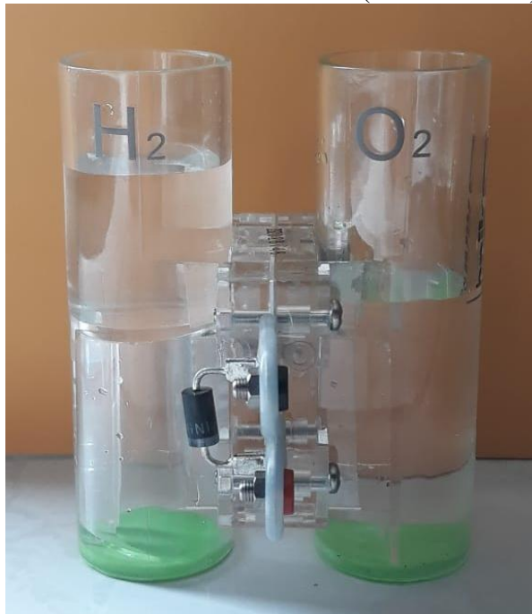
FIGURA 2. Célula de combustível (HYDRO CELL)
