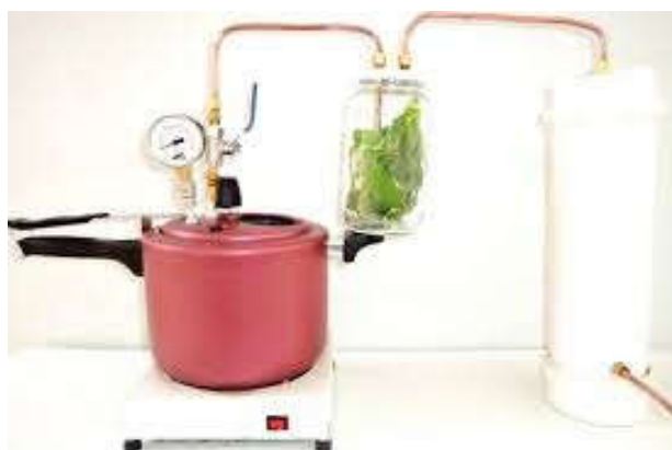
Figura 4: Sistema de destilação a vapor adaptado por VALENTIN e SOARES, 2018.
