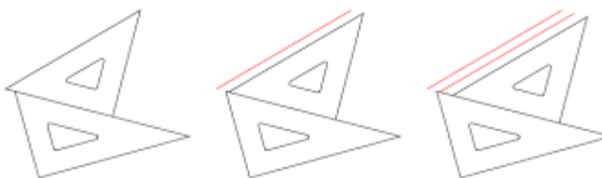
Figura 41 Traçando retas paralelas com esquadros
