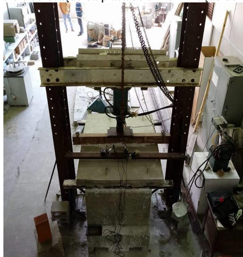
Figura 3 - Laje sobre apoio e colocação da placa de uniformização do carregamento sobre a laje.
