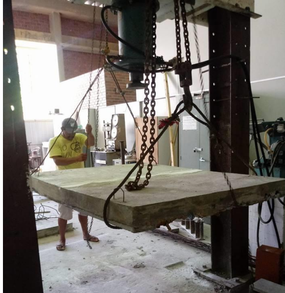
Figura 2 – Içamento de uma das lajes no pórtico para ser submetida ao ensaio de Flexão Simples.
