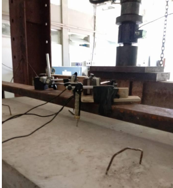
Figura 4 - Transdutores responsáveis pela leitura do deslocamento vertical.
