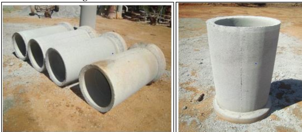
Figura 04 – Tubos de manilhas de concreto.
