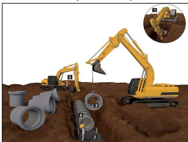
Figura 05 – Processo de instalação da tubulação de manilhas de concreto.
