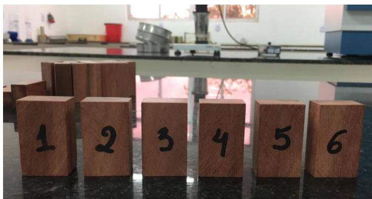
Figura 7 - Corpos de prova para determinação da umidade da Maçaranduba.
