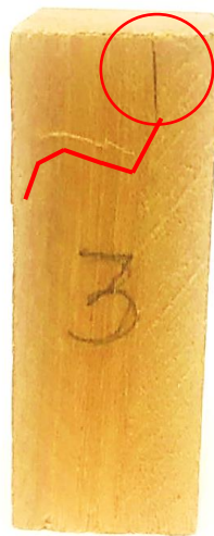
Figura 15 - Trinca apresentada pela abertura no 3º corpo de prova da madeira Tatajuba.
