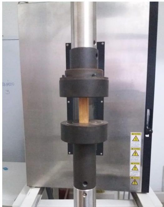
Figura 11 - Unidade de corpo de prova submetida a compressão paralela às fibras.
