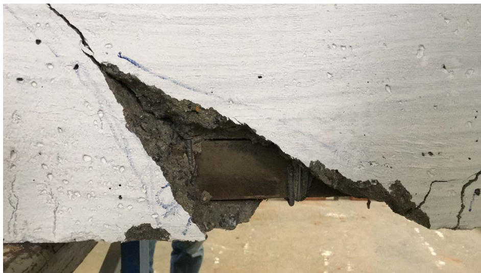
Figura 37 - Exposição do reforço de madeira.
