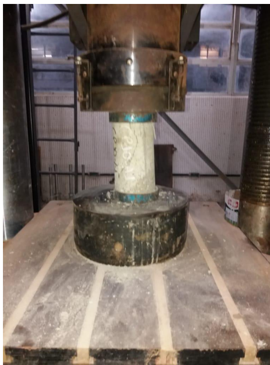
Figura 17 - Corpo de prova da pré-moldagem submetido a carga axial de compressão.
