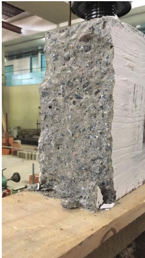
Figura 27 - Seção interna transversal da viga de concreto simples
