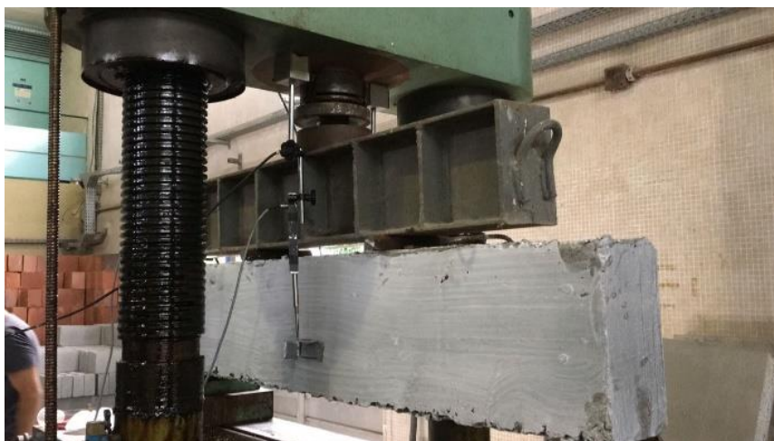
Figura 23 - Viga montada em maquinário para submissão ao ensaio de flexão pura.
