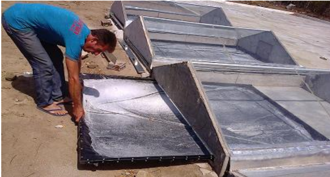
Figura 4: Retirada da lona Encerado para a limpeza dos sais acumulados após o processo de destilação das águas.
