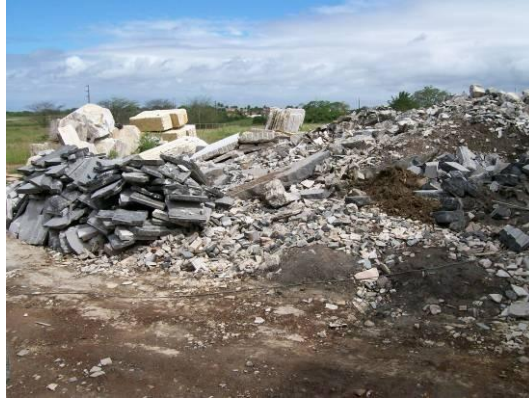
Figura 4.3 - Costaneiras armazenadas no pátio Fonte: Autor
