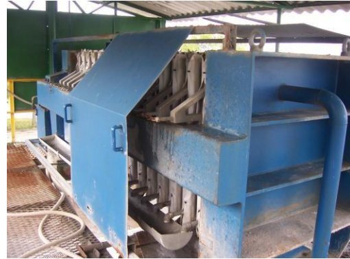
Figura 4.1 (b) - Filtro prensa da ETE Fonte: Autor
